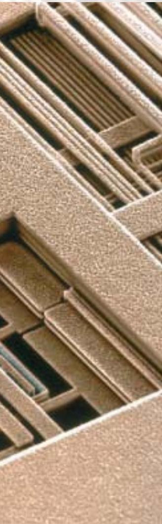
*Komplex wie eine Stadt – freigeätzte Kupferverdrahtung eines Chips (IBM), abgebildet mit dem Rasterelektronenmikroskop. Moderne Chips haben bis zu 9 Verdrahtungsebenen.*
