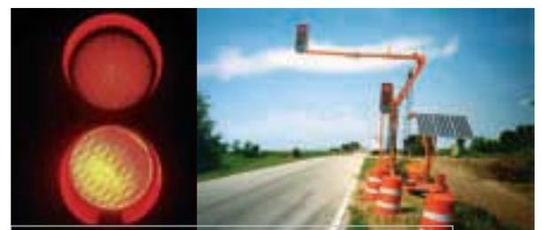
*LEDs in Ampeln sparen Servicezeit und Energie. Die Amortisationszeit liegt bei nur einem Jahr.*
