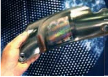
Das Institut für Neue Materialien in Saarbrücken, INM, hat Nanopartikel-Verfahren entwickelt, Metallteile mit fälschungssicheren, abriebfesten Hologrammen zu beschichten.
