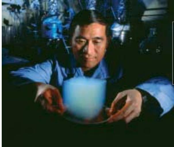
Aerogel als wissenschaftlicher Staubfänger. Auftreffende Partikel werden sicher in geschmolzener Aerogelmasse eingeschlossen.
