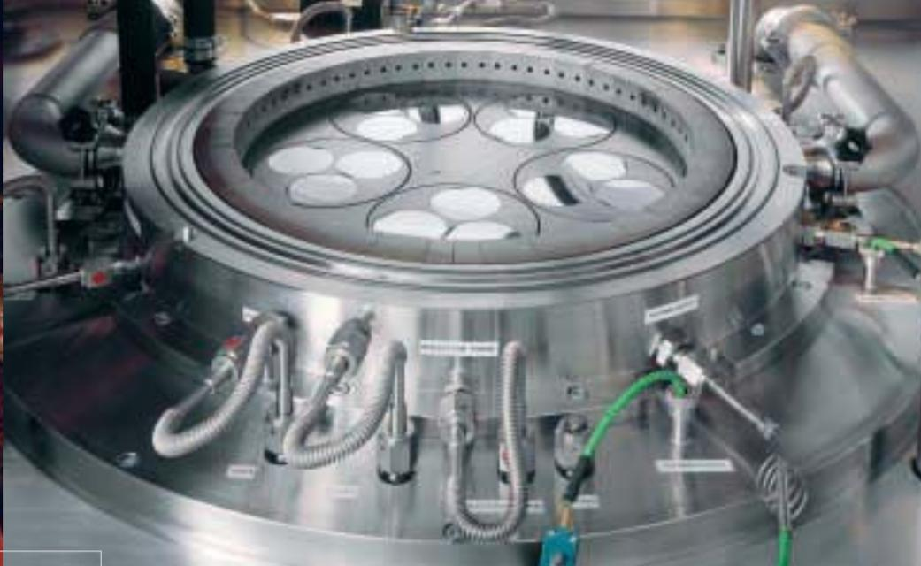
*Aixtron-Reaktoren für die Forschung (links) und zur atomgenauen Herstellung dünner Schichten aus Verbindungshalbleitern (rechts)*
