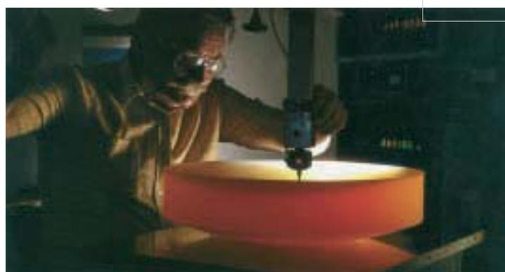
Mit Stempeln in den Nano-Kosmos: Am Institut für Halbleitertechnik (IHT) der RWTH Aachen sind mit mechanisch/optischen Methoden bereits Chip-Strukturweiten von 80 Nanometern realisierbar. Anwendung: Kleinserien hochkomplexer Schaltungen.
