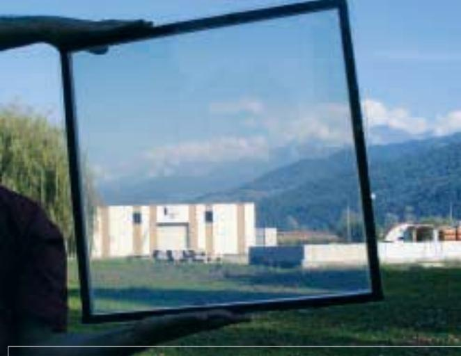
Mit Aerogel aufgefüllte Doppelverglasung stoppt Wärmeverluste.
