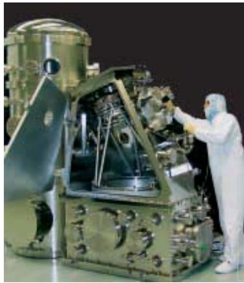
Prototyp einer EUV-Waferstepper-Anlage für die Produktion zukünftiger Chip-Generationen
