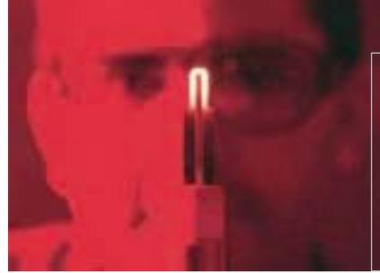
Auch das kann die Natur nicht: Mit Nanoruß dotierte Keramik für korrosionsfeste Glühzünder, etwa für Gasthermen. Die einstellbare Leitfähigkeit der Keramik erspart einen Transformator.
