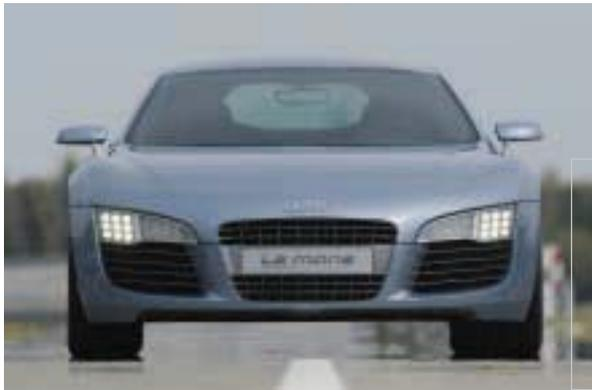
Weißer LEDs sind so lichtstark geworden, dass sie zukünftig als Lichtquellen für Tageslicht-Front-scheinwerfer eingesetzt werden können.
